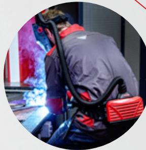
La confiable unidad de filtro y ventilador filtra hasta un 99.8% de partículas peligrosas del aire ambiente en los alrededores del soldador.
